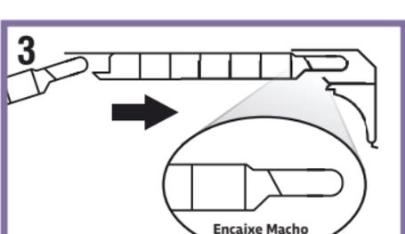
Com o REVID ajustado, encaixe-o no acabamento. O encaixe macho deve ficar para o fundo do acabamento, dando frequência na instalação sempre encaixando o ENCAIXE MACHO no ENCAIXE FÊMEA. A identificação PLASBIL NBR 14285 deve estar voltada para a cobertura. Siga a sequência de encaixe.
