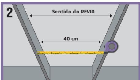
A distância mínima em relação ao telhado deve ser de 1 m e o espaçamento máximo da estrutura de fixação deve ser de 40 cm.
