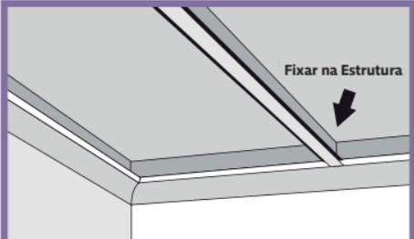
Quando o REVID for menor do que o ambiente, utilize a Emenda Rígida antes de iniciar a instalação. Lembre-se, o REVID é produzido nas medidas de 2,70 m, 4,00 m e 6,00 m.
