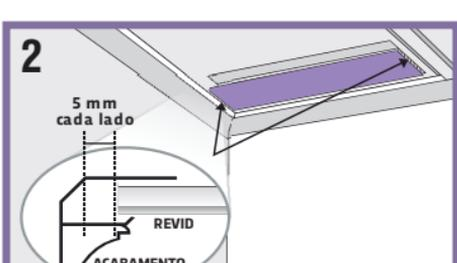
Deixe uma folga de 5 mm entre o REVID e a extremidade do acabamento escolhido, de ambos os lados, para evitar ondulações devido a dilatação do policloreto de vinila.
