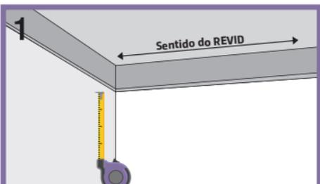
Defina o sentido em que o REVID será instalado. Marque a altura em relação ao solo em que o REVID será instalado. A marcação deve ser feita em todos os cantos das paredes e, depois, marque em todas as paredes no mesmo nível.
