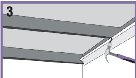
Ajuste o comprimento do Acabamento Premium ou Nobre em relação a parede e fixe o mesmo em toda sua extensão diretamente na parede ou na estrutura de fixação.
