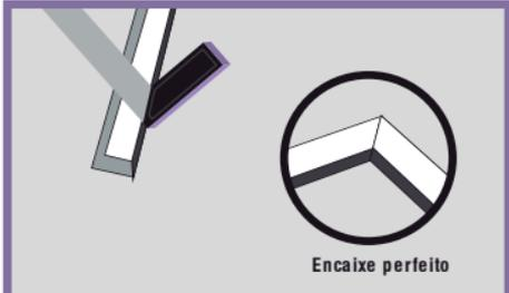
Para a instalação do Acabamento Convencional, nos cantos faça um corte diagonal (meio esquadro, 45°) para obter o encaixe.
