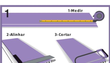
Ajuste o comprimento do REVID de acordo com o tamanho do ambiente no qual será aplicado. Lembre-se, o REVID é produzido nas medidas de 2,70 m, 4,00 m e 6,00 m.
