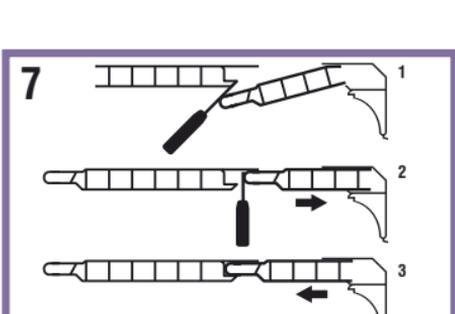
Encaixe o lado cortado nas duas extremidades dentro do acabamento. Mesmo que fique sobreposto ao perfil do REVID anterior. Com a ajuda de uma espátula empurre o perfil do REVID sobreposto contra o fundo do acabamento em toda sua extensão (1). De pois empurre o encaixe macho contra o encaixe fêmea do perfil do REVID anterior (3).
