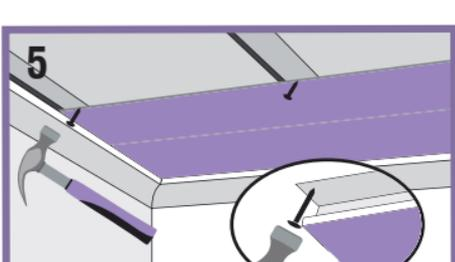
Após encaixar o REVID, fixe-o em todas as travessas da estrutura de sustentação. Dê sequência à instalação até o último perfil.
